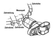
Für beste Ergebnisse empfehlen wir Zielobjekte aus kohlenstoffarmem, kaltgepresstem Stahl. Zu den weiteren Faktoren, die die Sensorleistung beeinflussen, zählen die Zahnhöhe und -breite, die Zahnteilung, die Form der Zähne und die Dicke des Zielobjekts. Als allgemeine Leitlinie empfehlen wir, die folgenden Minimalwerte für das Zielobjekt zu berücksichtigen. Beachten Sie bitte, dass der Sensor auch mit kleineren Zielobjekten funktionieren kann, hierfür aber anwendungsbezogene Tests nötig sind.
